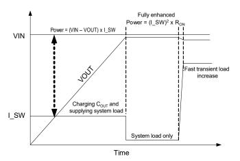
Figure 9. Soft-Start Power Dissipation
