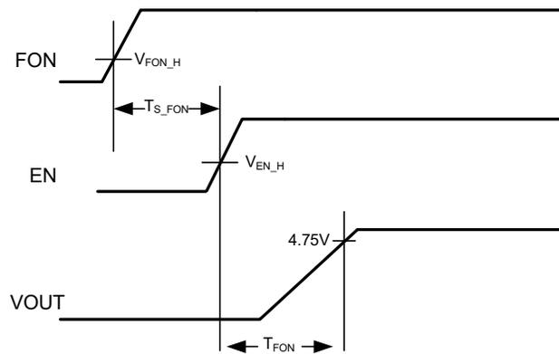
Figure 2. Fast Turn-on Time ( $V_{IN}=5V$ )
